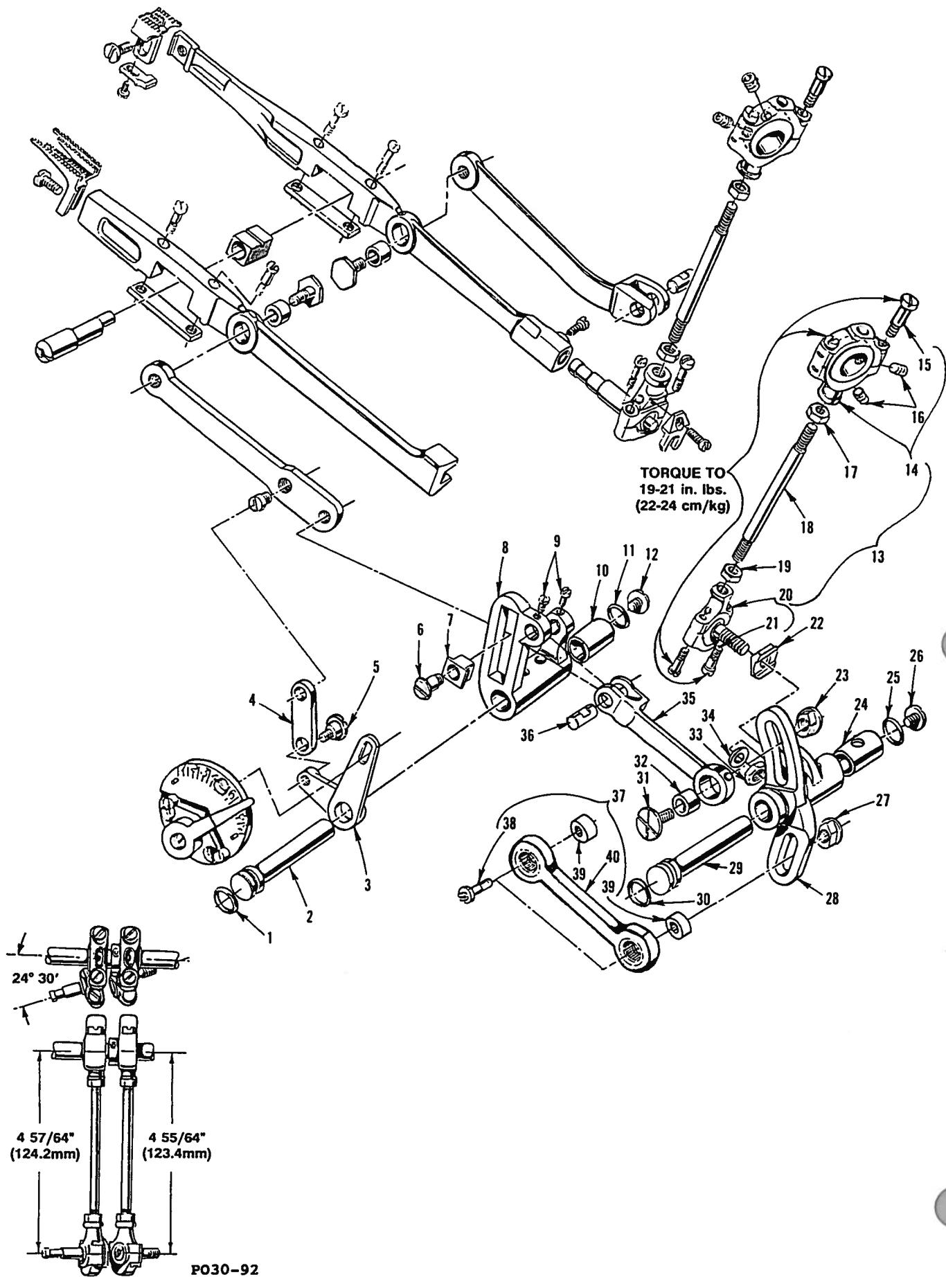
FEED DRIVE ASSEMBLY, FEED ROCKER & LOOPER AVOID PARTS
